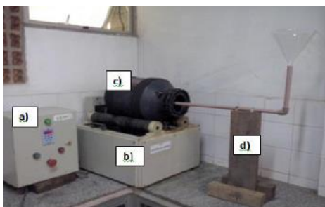
Figura 1 - Conjunto de Equipamentos de Aglomeração: a) Inversor de Frequência; b) Equipamento de Rotação do Moinho de Jarros; c) Tambor de Aglomeração; d) Sistema de Tubulação.
